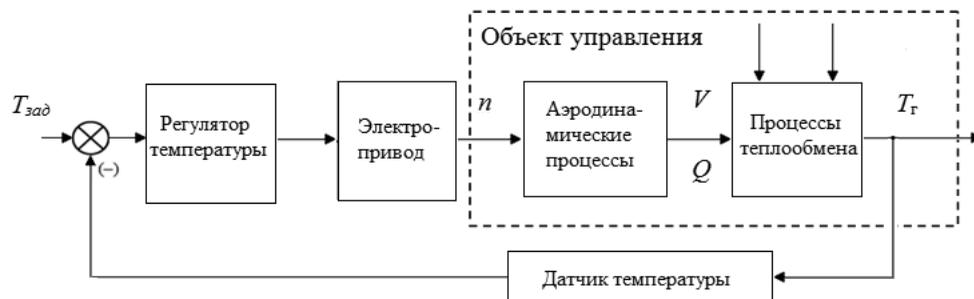
Рис. 4. Функциональная схема САУ температурой газа на выходе АВО
