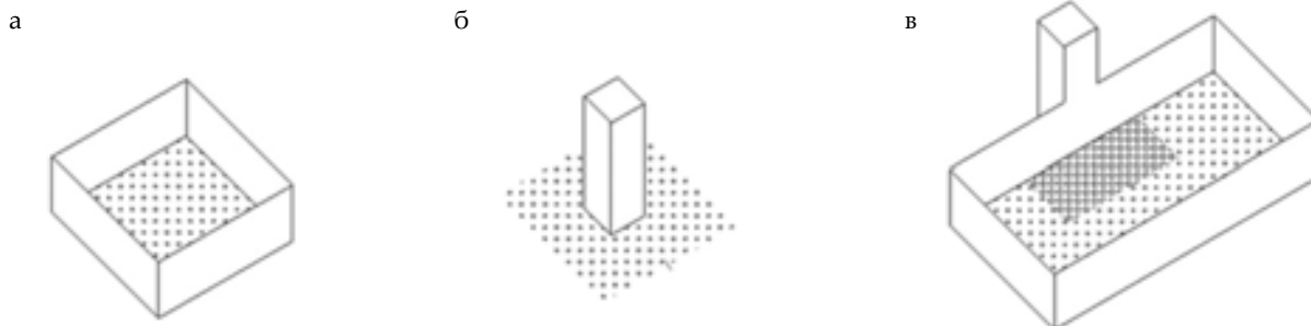
Рис. 2. Схемы организации пространств границами: а – объект собирает пространство вокруг себя; б – пространство организовано внутри границ; в – объект организует пространство перед собой в составе другого пространства (смешанный тип)
