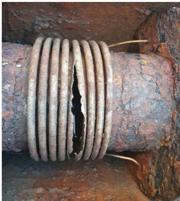
Рис. 2. Осевой сильфонный компенсатор с дефектом – разрывом сильфона
