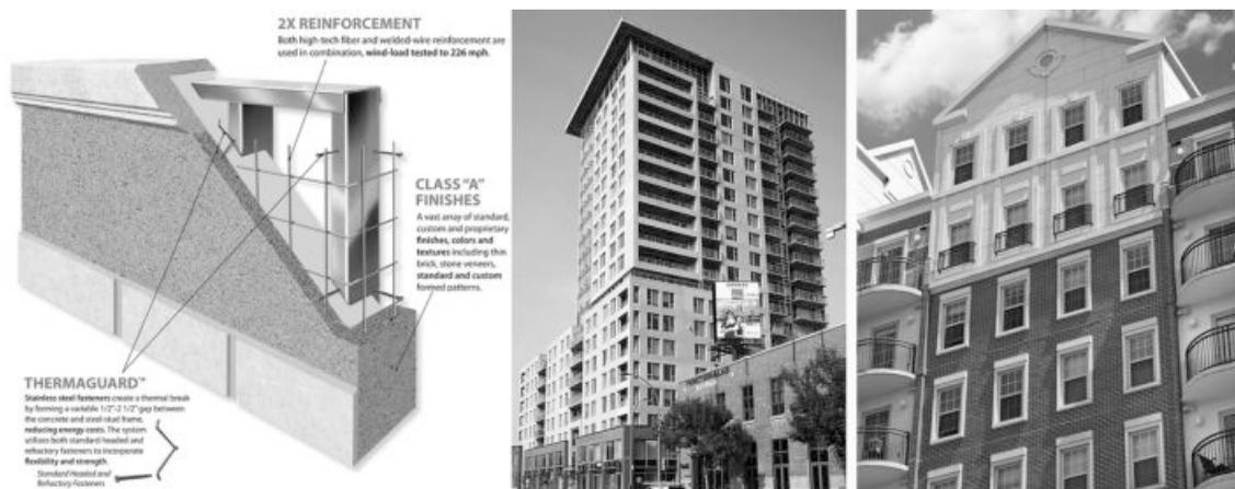
Рис. 8. Архитектурная сборная модульная комбинированная система «SlenderWall»
