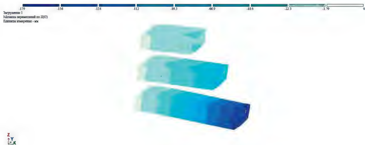
Рис. 10. Мозаика перемещений по оси Z (мм) консолей пролетом 21, 30 и 39 м
