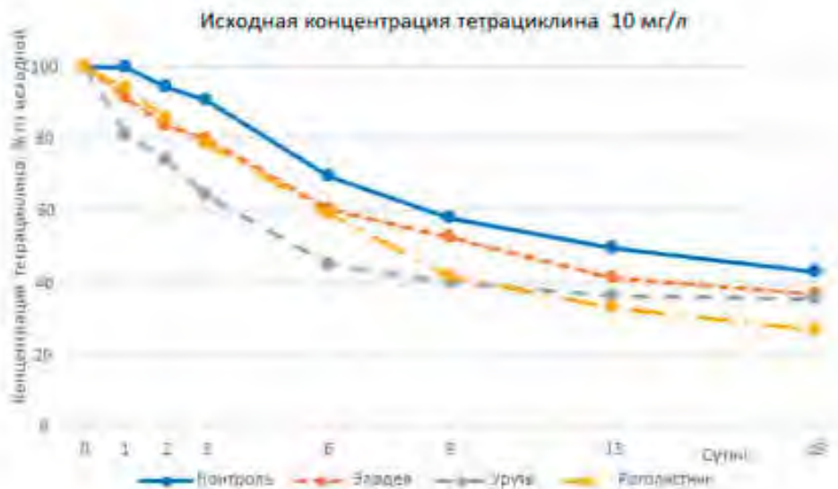
Рис. 5. Изменение концентрации тетрациклина в водных растворах в присутствии водных растений при исходной концентрации тетрациклина 10 мг/л
