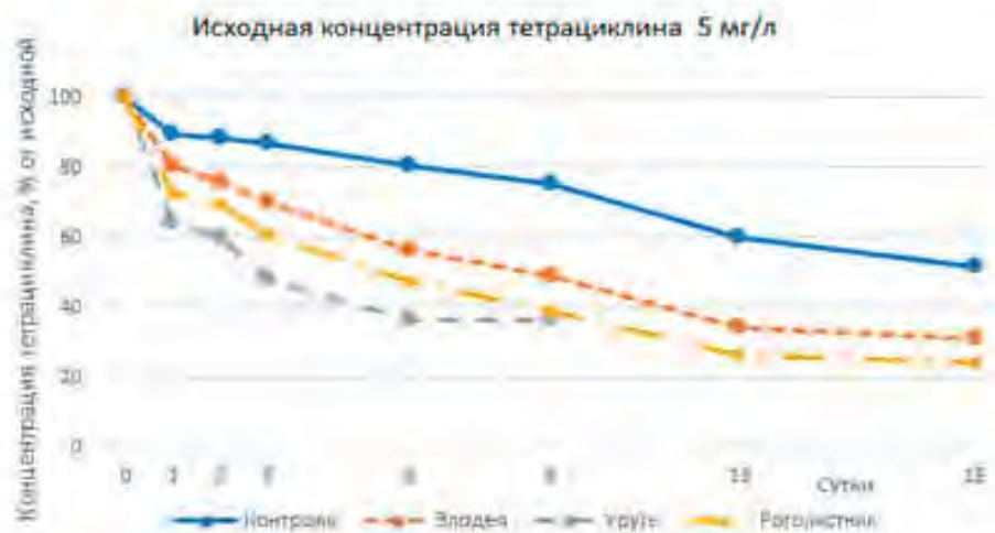
Рис. 4. Изменение концентрации тетрациклина в водных растворах в присутствии водных растений при исходной концентрации тетрациклина 5 мг/л
