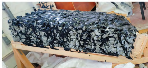
Рис. 2. Экспериментальный образец плиты из крупнопористого бетона, пролитого битумом
