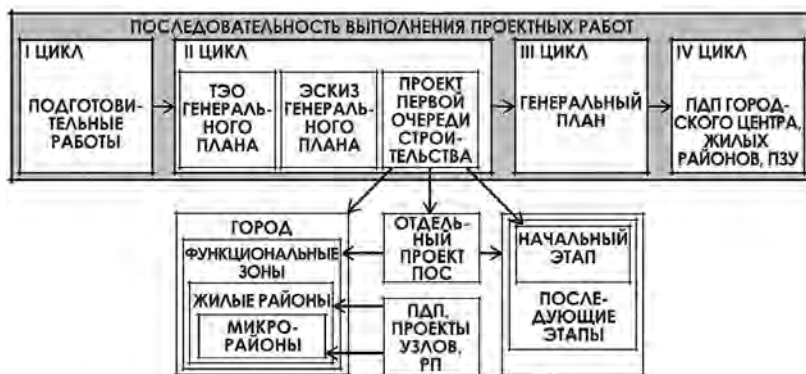
Рис. 5. Взаимосвязь проектных работ, в т.ч. первоочередных проектных работ, с этапами реализации (составлено авторами по материалам Руководства по проектированию новых городов, 1982 г.) [9, с. 25]
