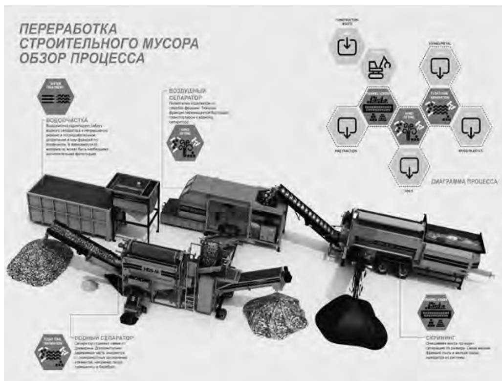
Рис. 1. Основные технологические этапы процесса переработка строительных отходов
