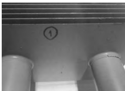
Рис. 7. Образец 1. Вид спереди при натяжении 0,5 мм
