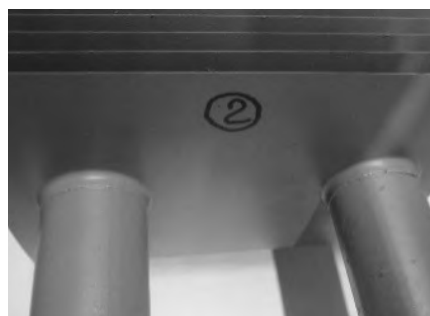
Рис. 8. Образец 2. Вид спереди при натяжении 0,6 мм
