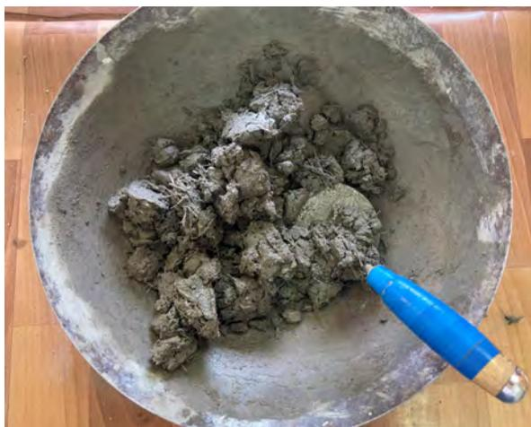
Рис. 2. Комкование при добавлении фибры в сухом виде
