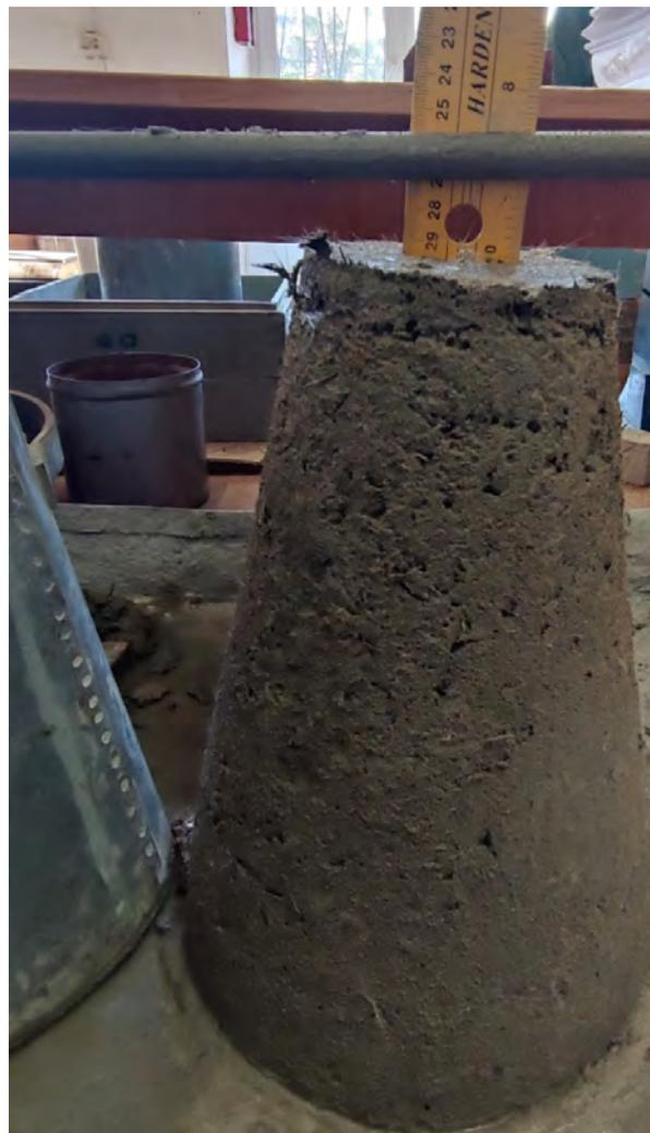
Рис. 5. Определение подвижности фибробетонной смеси
