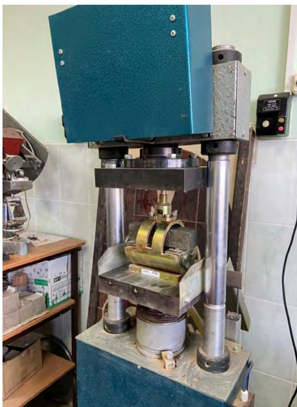
Рис. 3. Процесс испытания образцов на растяжение при изгибе
