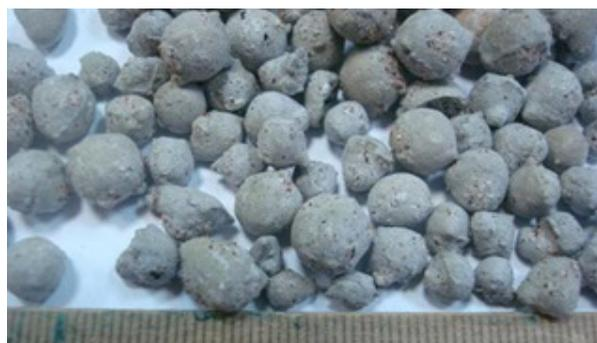
Рис. 1. Гранулы после обжига при 850 °С
