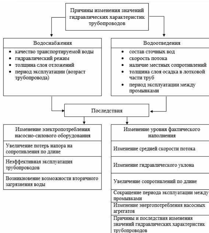
Рис. 2. Причины и последствия изменения значений гидравлических характеристик трубопроводов водоснабжения и водоотведения
