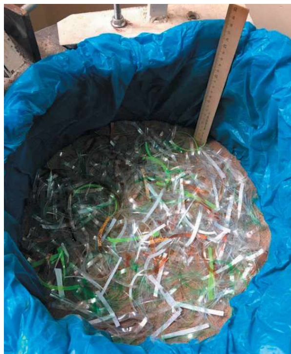
Рис. 2. Процесс смешивания грунта с полосками полиэтилентерефталата
