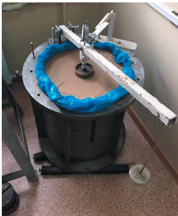
Рис. 1. Общий вид лабораторной установки штамповых испытаний грунтов
