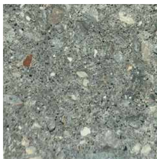
ж) на основе цемента, волжского песка и отсева дробления карбонатного щебня Сокского карьера
