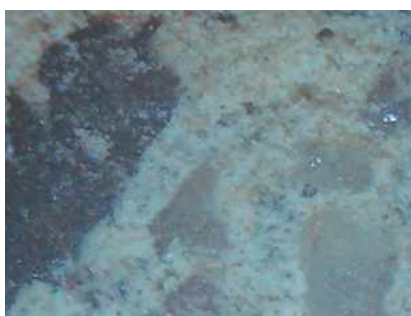
д) на основе цемента, волжского песка и отсева дробления гранитного щебня Орского карьера
