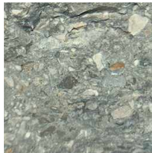
г) на основе цемента и отсева дробления карбонатного щебня Сокского карьера
