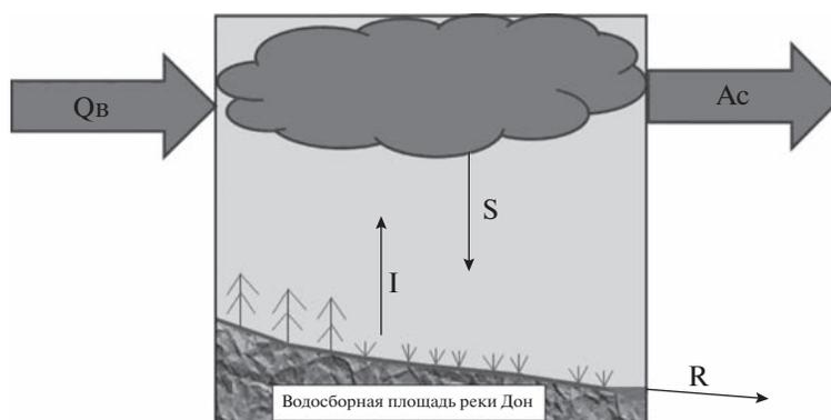
**Рис. 1.** Схема водообмена в бассейне Дона.  $Q_v$  – водяной пар, поступающий извне;  $S$  – осадки внешнего происхождения и местные;  $I$  – испарение;  $R$  – речной сток;  $A_c$  – атмосферная влага, покидающая бассейн Дона.
