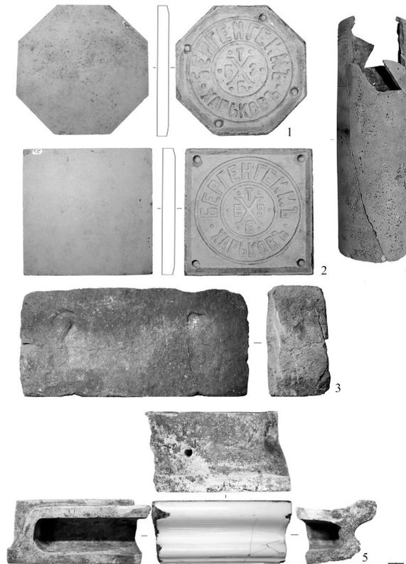
Рис. 4. Предметы домостроительства: 1, 2 — облицовочные плитки, 3 — кирпич с клеймом, 4 — водопроводная труба, 5 — печной изразец.
