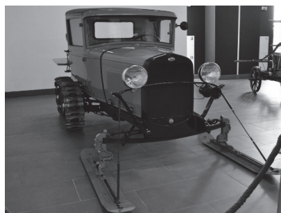
Модифицированный Ford A для передвижения по снегу с лыжно-полугусеничным шасси.
