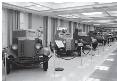
Броневики — бронированные варианты Ford A и его модификаций.
