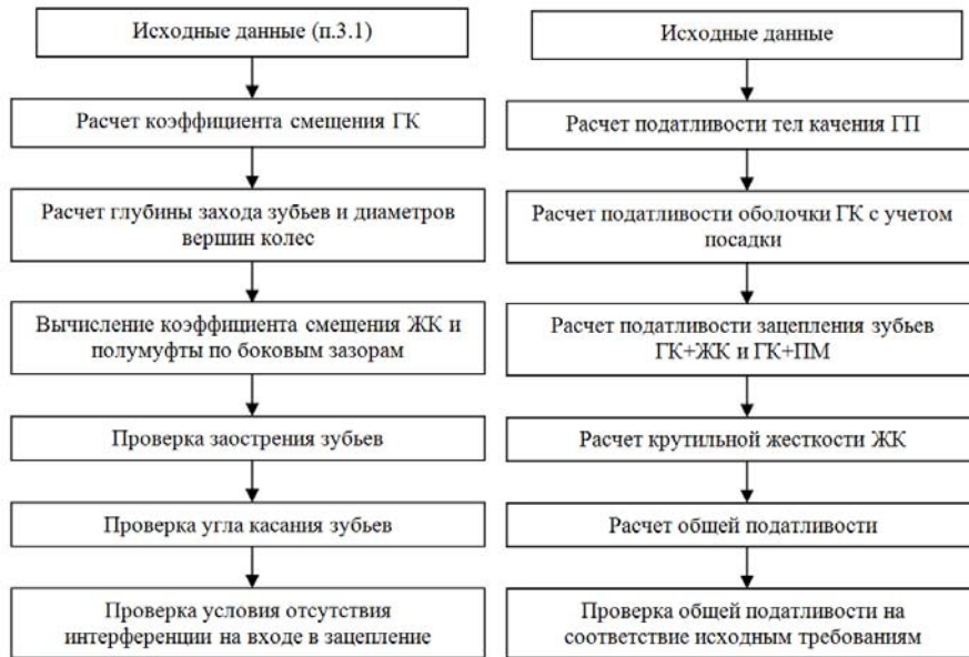
Рис. 1. Этапы проектирования ВЗП как выходной ступени высокоточного привода космического аппарата: ГК – гибкое колесо; ЖК – жесткое колесо; ПМ – полумуфта
