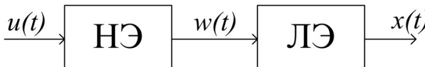
Рис. 3. Схема нелинейной системы: ЛЭ – линейная динамическая часть; НЭ – нелинейный элемент системы;  $u(t)$  – входное воздействие;  $w(t)$  – выход промежуточного звена объекта;  $x(t)$  – выход объекта
