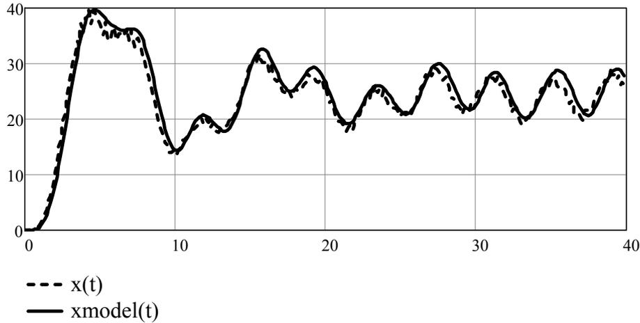
Рис. 4. Результат оценки выхода  $x(t)$ :  $xmodel(t)$  – модель нелинейной системы;  $x$  – выход системы; объем выборки  $s = 300$ ,  $\Delta t = 0,117$ , помеха 5 %, входное воздействие:  $u(t) = 4\sin(0,8t)$ , относительная ошибка моделирования 3,2 %
