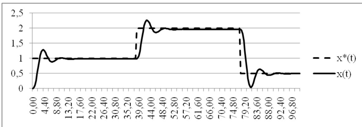
Рис. 7. Управление динамическим объектом:  $x(t)$  – выход управляемого объекта;  $x^*(t)$  – желаемое значение выхода, помеха 5 %,  $W = 0,15$
