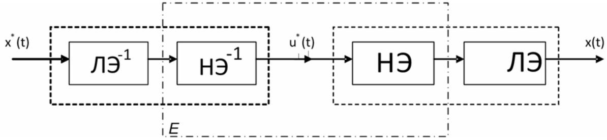
Рис. 5. Схема функционирования непараметрического регулятора: E – единичный оператор; ЛЭ<sup>-1</sup> – оператор, обратный к ЛЭ системы; НЭ<sup>-1</sup> – оператор, обратный к НЭ
