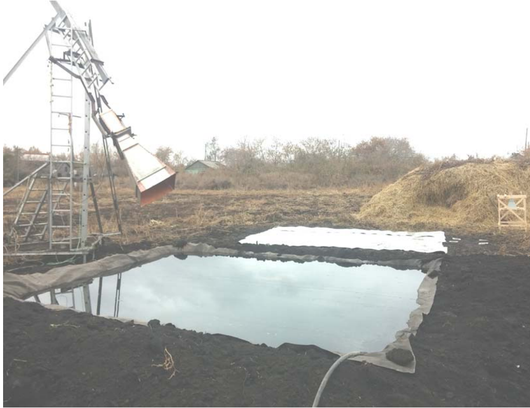
Рис. 1. Процесс калибровки радиометра над водой и металлическим экраном
