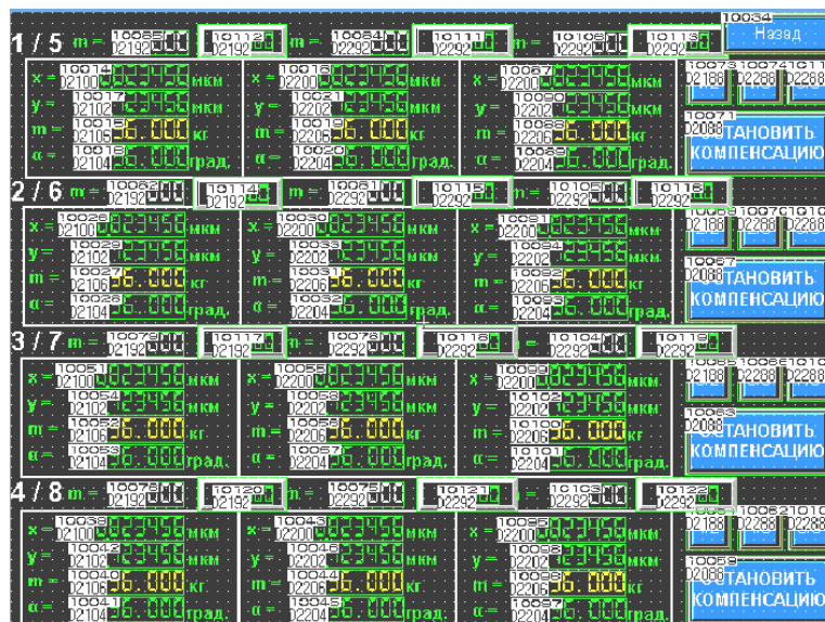
Рис. 5. Пример настройки для четырех спиц антенны
