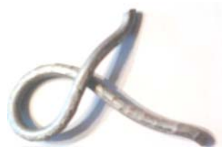
Рис. 7. Изгиб прутка \varnothing 5 мм с волокнистой структурой
