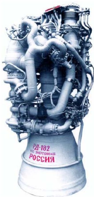
Рис. 1. Пример компактного расположения трубопроводов со сложной пространственной геометрией на двигателе РД-182
