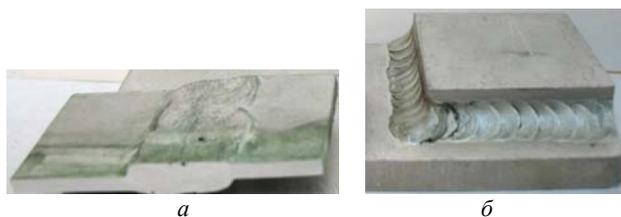
Рис. 3. Фрагменты сварки электродом, содержащим нанопорошок карбонитрида титана TiCN, листовой конструкции из листов сплава АМг6 толщиной: а – 5,0 мм; б – 8,0 мм
