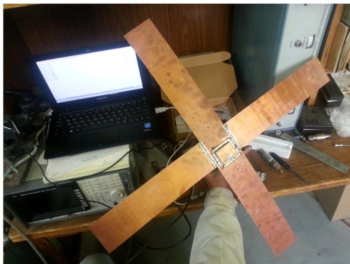
Рис. 10. Фото антенного макета сверхмалого КА CubeSat формата 1U с МПА 435 МГц
