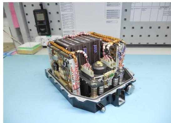
Рис. 2. МБИС на импортной элементной базе
