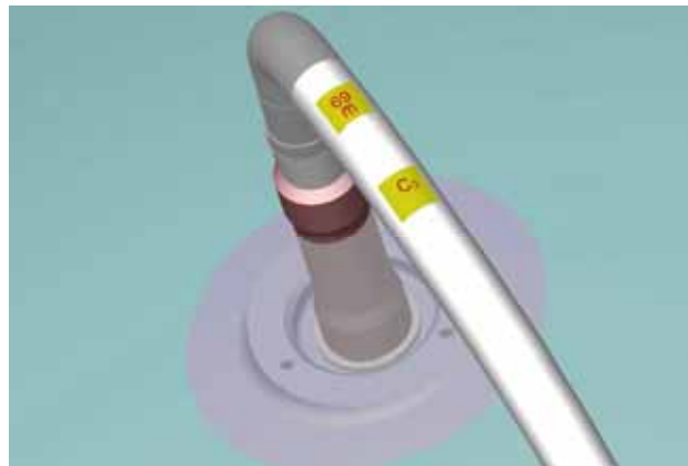
Рис. 13. Маркировка стыка трубопровода
