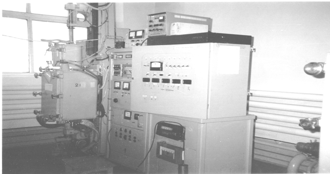
Рис. 2. Микропроцессорная система управления вытягиванием монокристаллов германия
