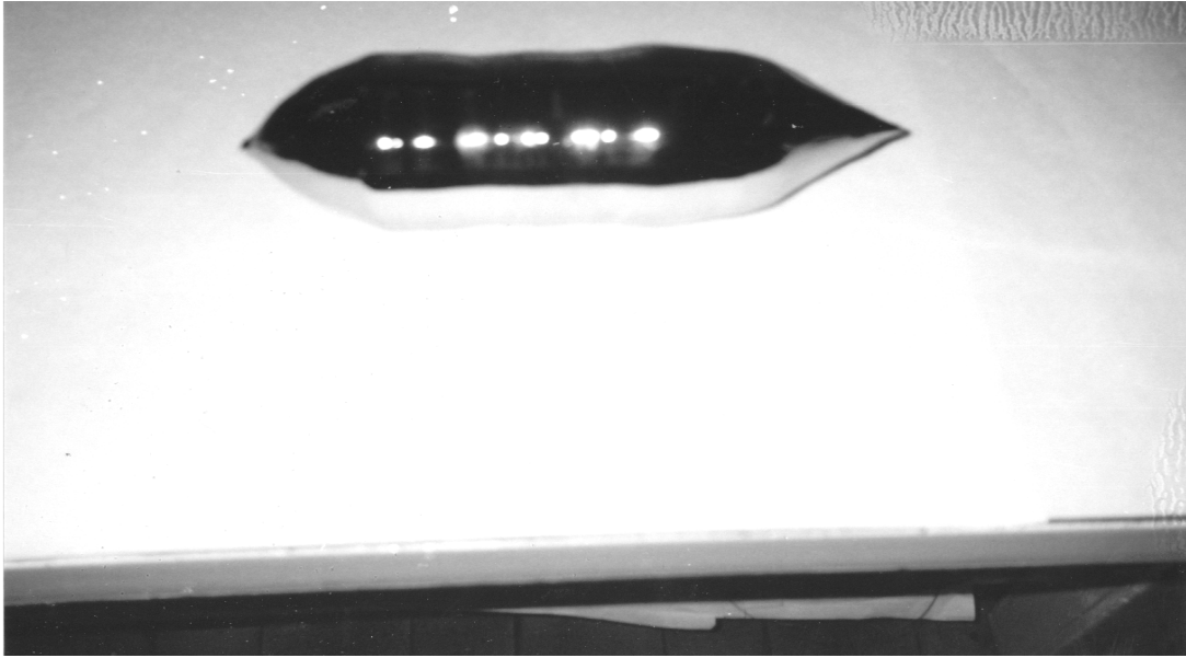
Рис. 4. Слиток германия диаметром 104 мм
