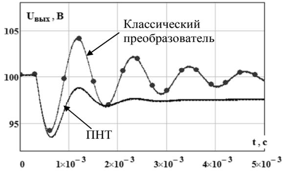
Рис. 5. Переходной процесс выходного напряжения при изменении выходной мощности от 150 до 300 Вт
