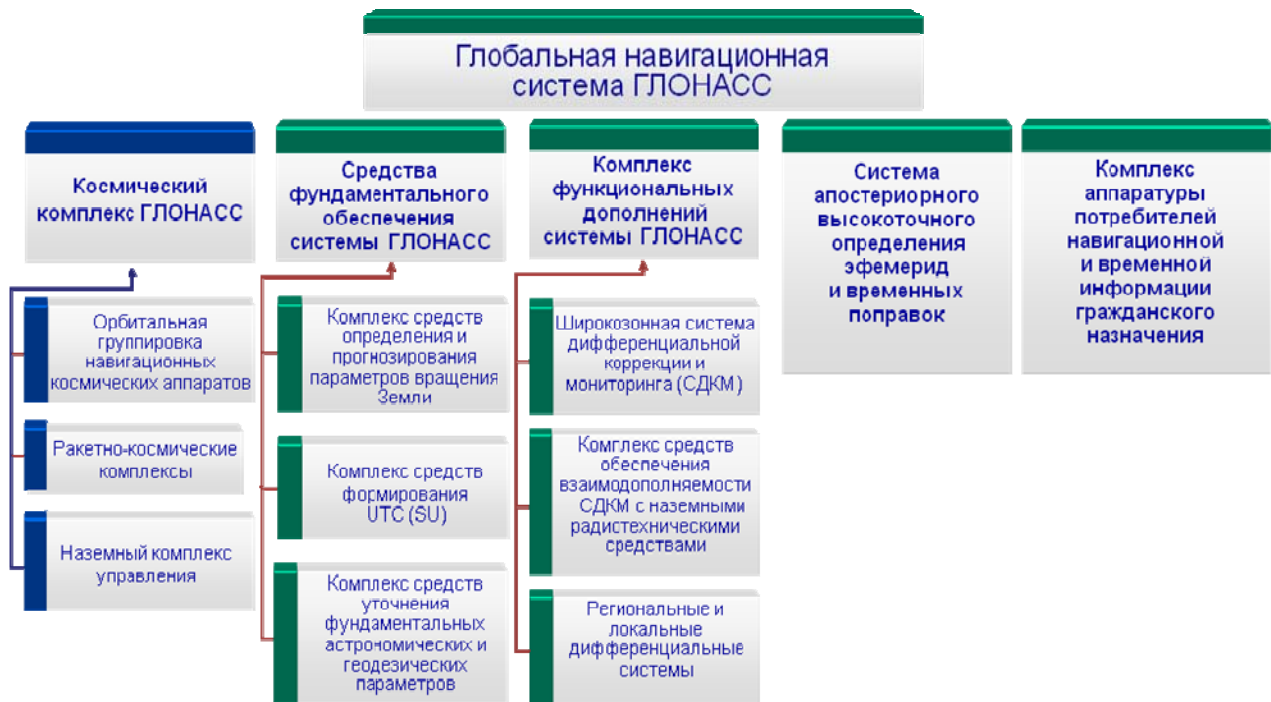
Рис. 2. Состав системы ГЛОНАСС
