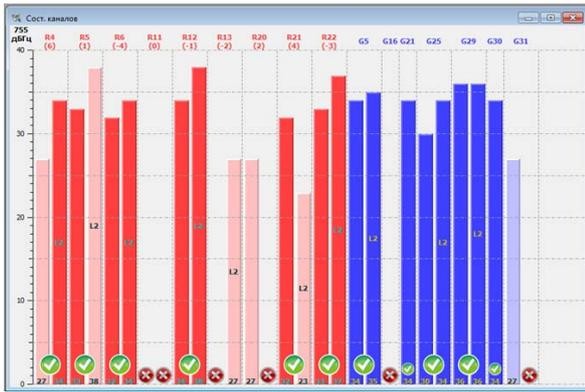
Рис. 2. Контроль состояния каналов приемника
