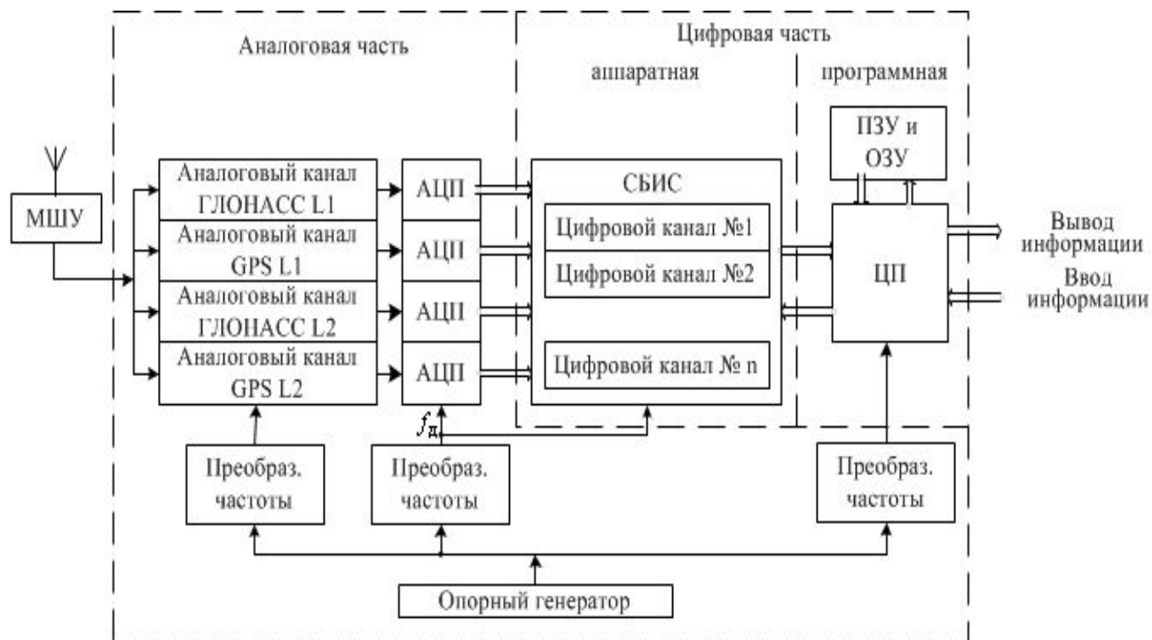
Рис. 2. Блок-схема многоканального навигационного приемника
