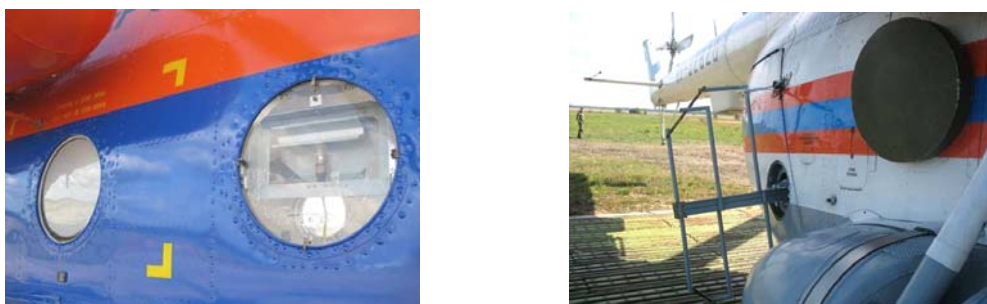
Рис. 1. Размещение антенн X- и L-диапазонов в иллюминаторах, вид снаружи (слева) и размещение антенн Р- и VHF-диапазонов (справа). Антенна Р-диапазона крепится за иллюминатор, а антенна VHF-диапазона устанавливается в штатный люк вертолета Ми-8
