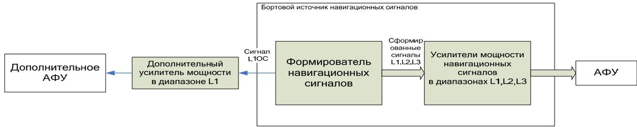
Рис. 6. Упрощенная схема доработки бортового источника навигационных сигналов
