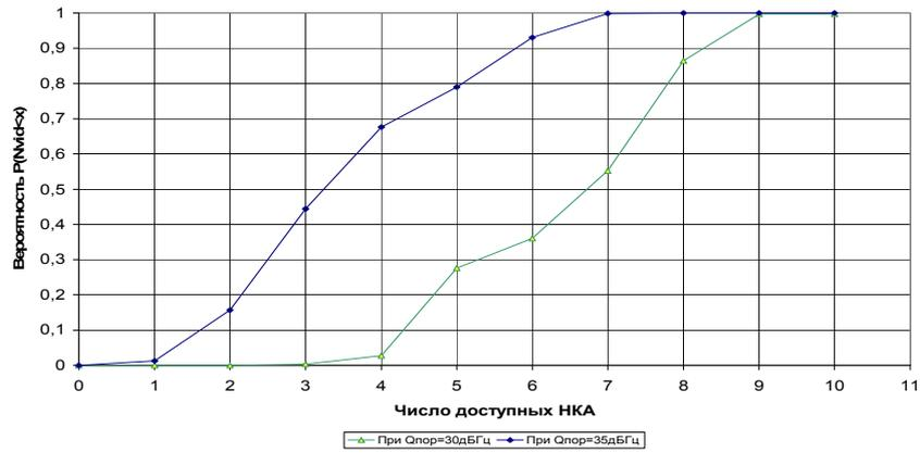
Рис. 8. Функция распределения вероятности числа одновременно доступных измерений по модернизированным НКА ГЛОНАСС для пользователя на ГСО
