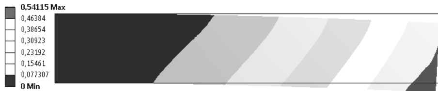
Рис. 5. Перемещения (мм), возникшие в результате закалки (контуром показана недеформированная модель, масштаб увеличен для наглядности)
