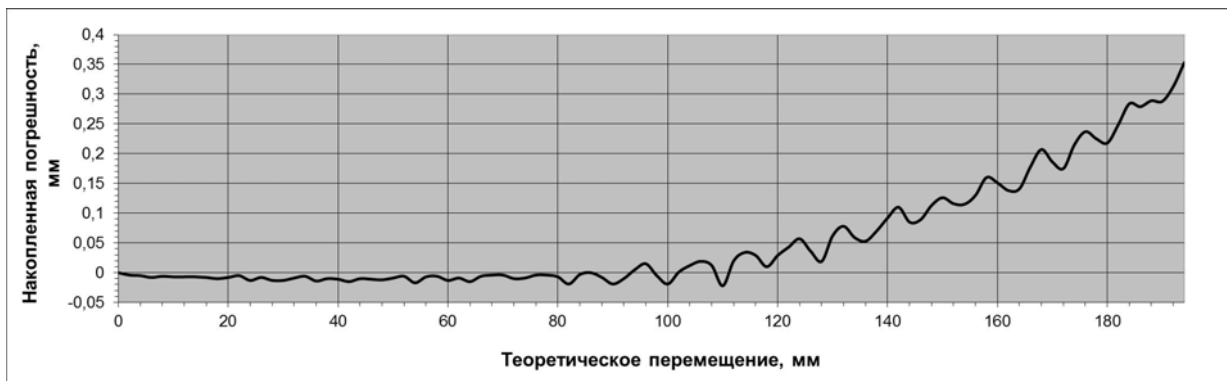
Рис. 8. Зависимость накопленной погрешности перемещения выходного штока привода от теоретического перемещения
