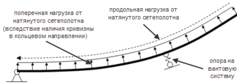
Рис. 5. Схема силового воздействия на профилированную спицу
