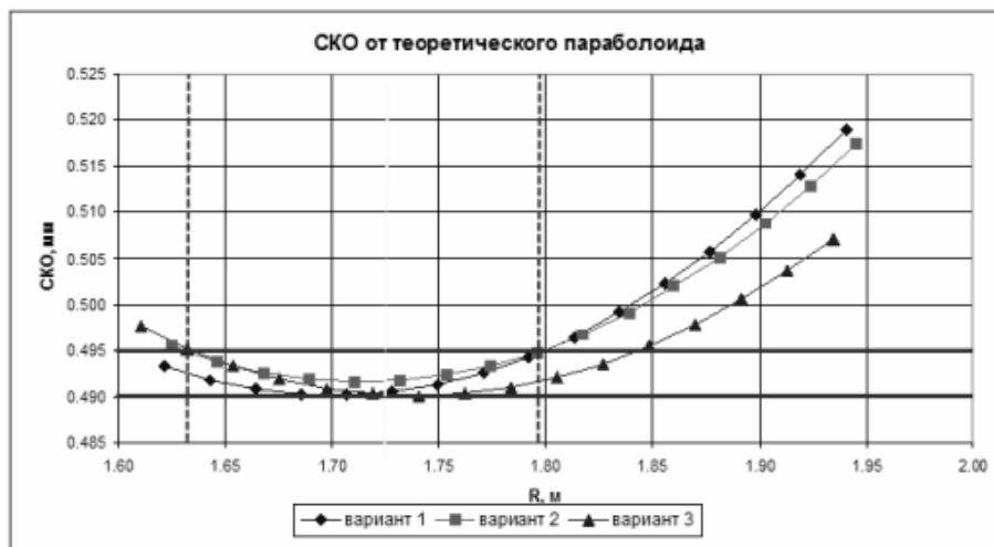
Рис. 7. СКО поверхности в невесомости от теоретического параболоида
