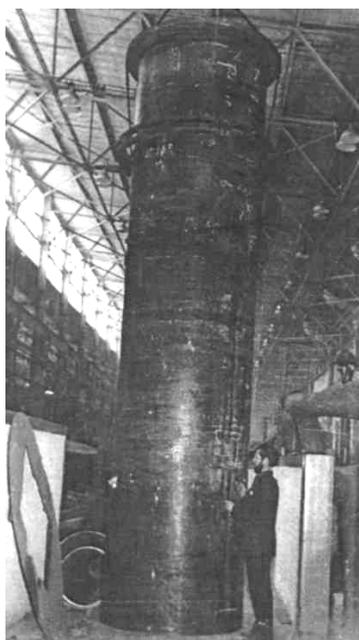
Рис. 8. Изложница кристаллизатора для вакуумной электродуговой выплавки крупных слитков титана. Плазменная сварка, материал БрХ08 толщиной 40 мм
