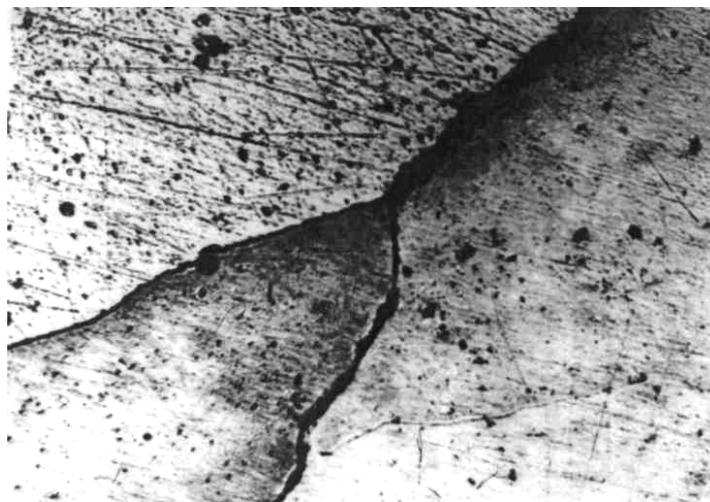
Рис. 2. Микротрещины в металле шва при плазменной сварке БрХ08 ( $\times 300$ ). Содержание хрома при сварке экспериментального образца менее 0,10 %
