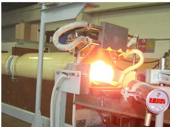
Рис. 1. Индукционный нагреватель цилиндрических слитков
