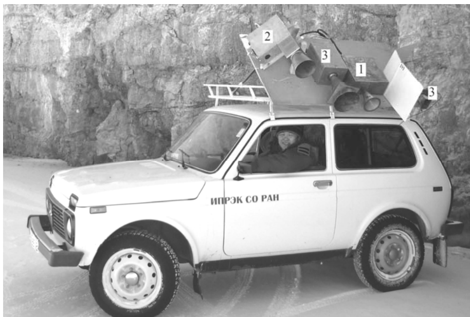
Рис. 1. Радиолокационная аппаратура, установленная на автомобиль. Радиометрические приемники: 1 – длина волны 2,3 см; 2 – длина волны 3 см; 3 – радиолокатор длину волны 5,6 см
