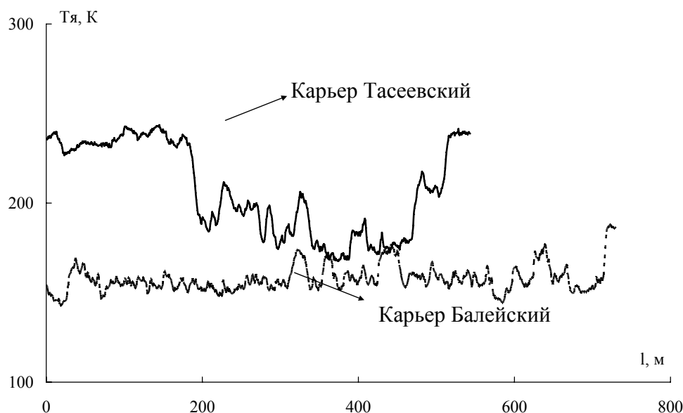
Рис. 2. Трассовая запись радиотермальной температуры ледяного покрова на длине волны 2,3 см. Вертикальная поляризация
