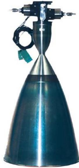
Рис. 2. Общий вид двигателя S400-12
