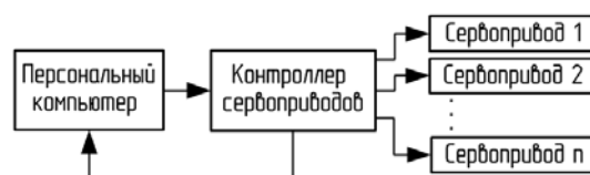
Рис. 1. Схема моделирования САУ на компьютере
