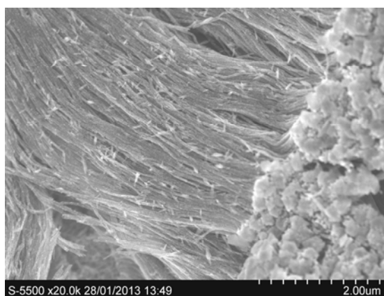
Рис. 5. РЭМ изображение тубуленов, освобожденных из матрицы
