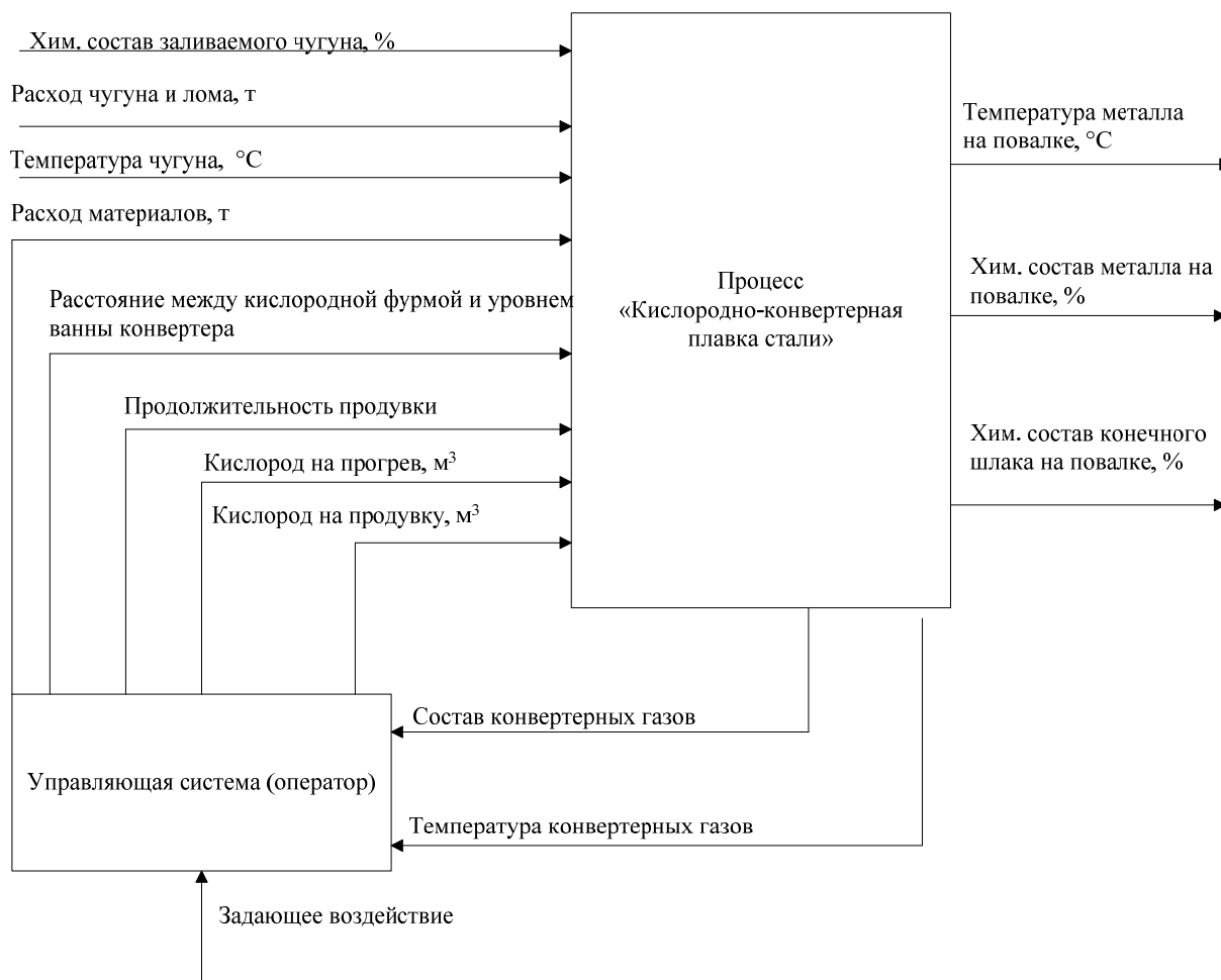
Рис. 1. Входные и выходные переменные процесса конвертерной плавки
