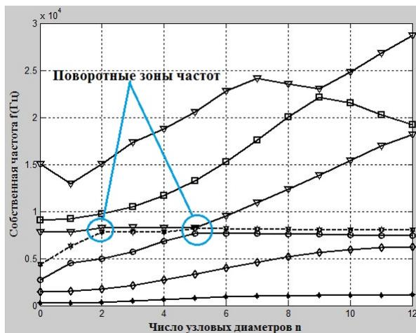
Рис. 3. График частот собственных колебаний «диск-лопатки» без расстройки в зависимости от числа узловых диаметров  $n$  и узловых окружностей  $m$
