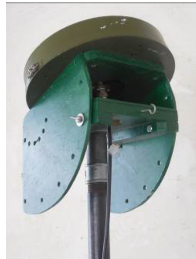
Рис. 2. Антенна правой круговой поляризации приемника ГНСС, снабженная поворотным устройством
