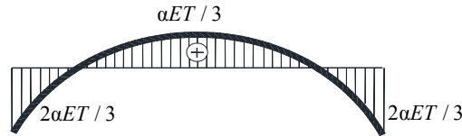
Рис. 4. Эпюра напряжения \sigma_x в поперечном сечении стержня, полученная методом сопротивления материалов
