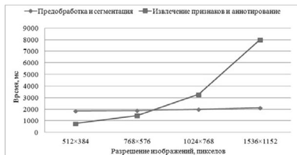
Рис. 4. График зависимости времени выполнения алгоритмов от разрешения изображения
