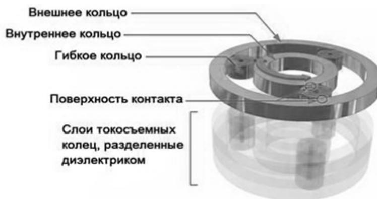
Рис. 1. Модель кольцевого токосъемного устройства
