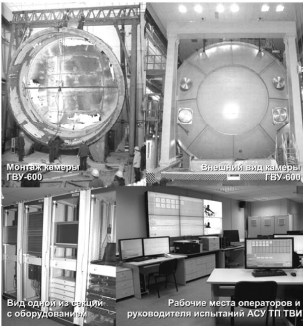
Рис. 1. Крупноразмерная горизонтальная вакуумная камера ГВУ-600 с объёмом более 600 м<sup>3</sup>
