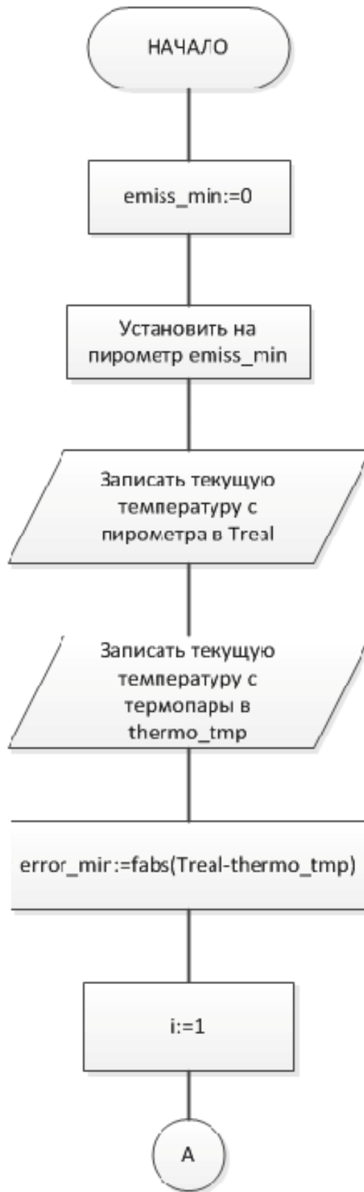
Рис. 11. Блок-схема вывода алгоритма подбора коэффициента излучательной способности материала на пирометре (начало)
