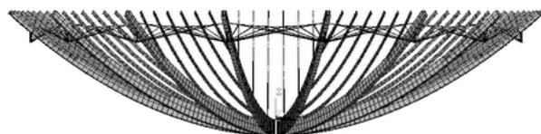
Рис. 2. Конечно-элементная модель рефлектора без сетеполотна
