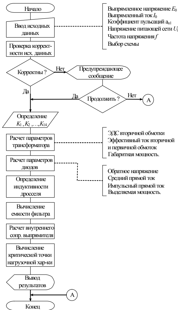
Рис. 7. Алгоритм расчета параметров выпрямителя с индуктивной реакцией нагрузки
