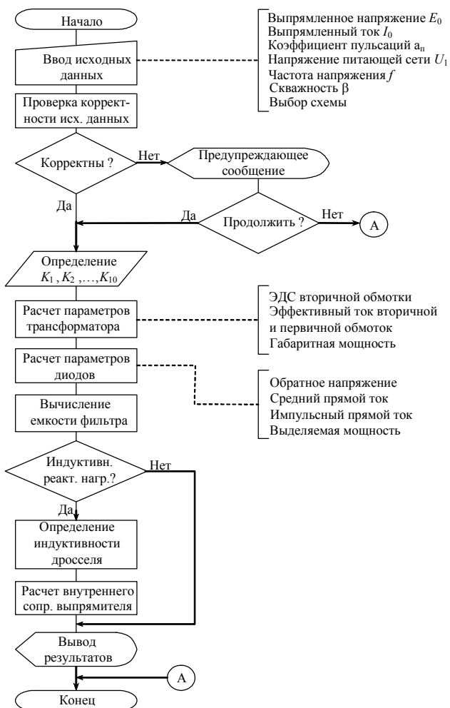
Рис. 8. Алгоритм расчета параметров выпрямителя, питаемого напряжением прямоугольной формы
