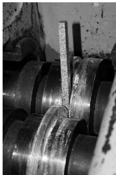
Рис. 3. Момент задачи заготовки в валки
