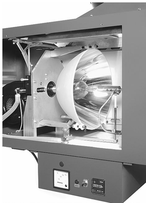
Рис. 5. Кинопроекторный аппарат Kinoton с лампой XBO
