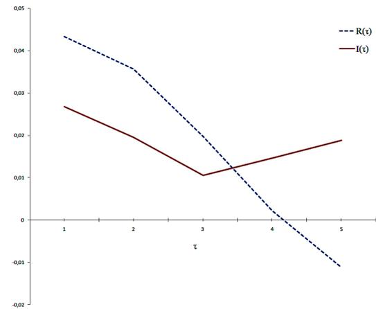
Рис. 4. График зависимости автокорреляционной функции  $R(\tau)$  и функции взаимной информации  $I(\tau)$  от временной задержки  $\tau$  для интервала 1870–2000 гг. с шагом 1 год
